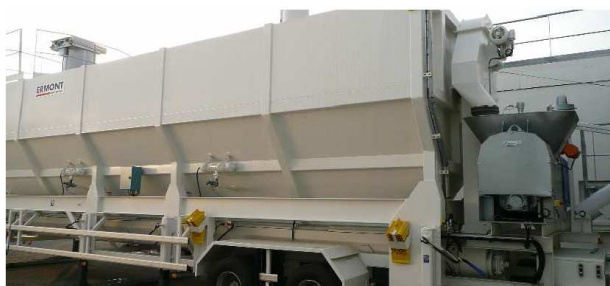
Illustration n° 7 : Silo à filler d'une centrale
